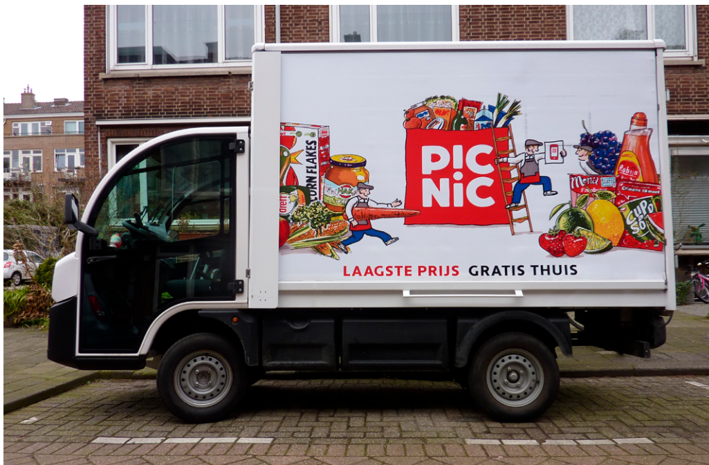
De onlinesupermarkt Picnic bezorgt met elektrisch aangedreven Mega e-Workers (slechts 1,30 meter breed). Er is keuze uit drie accupakketten: 8,6 kW, 11,6 kW en 17,3 kW. De actieradius varieert van 40 tot 100 kilometer, afhankelijk van het gebruik ( https://www.eco-mobiliteit.nl/site/mega-e-worker ).
